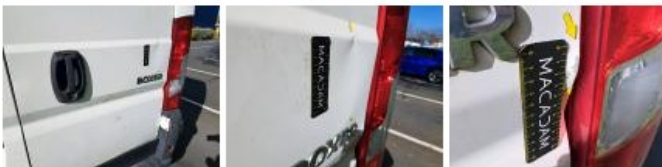
Porte de malle AR D, Bosse(s) et griffe(s), LI - Réparer et peindre (complet)
