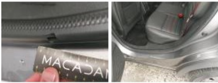
Bas de caisse int ARG, Bosse(s) et griffe(s), LI - Réparer et peindre (complet)
