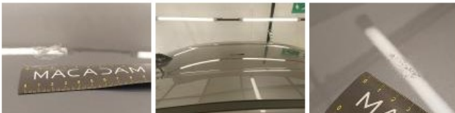
Pavillon, Dégâts chimiques, Peindre
