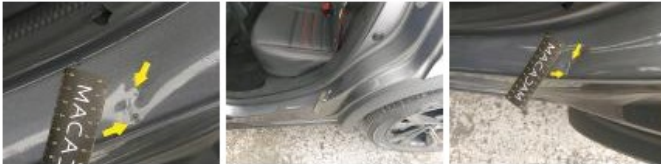
Garniture porte AVD, Déchirure, Réparer/remplacer (montant forfaitaire)
